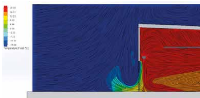
Teplotní pole v příčném řezu [°C]
